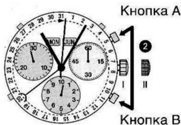
❷ Держите кнопки **А** и **В** одновременно в нажатом положении в течение минимум 2 секунд (центральная секундная стрелка поворачивается на 360° → активируется режим корректировки).
