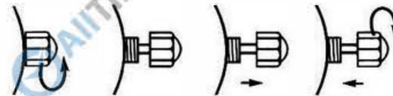
Некоторые часы, в частности модели, водонепроницаемые на глубине более 50 м (5 атм.), снабжены завинчивающейся заводной головкой. Это указано на этикетке часов. Прежде чем Вы сможете производить корректировки с помощью заводной головки, она должна быть вывинчена. При этом Вам необходимо поступить следующим образом:
