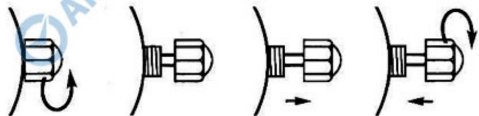
Некоторые часы, в частности модели, водонепроницаемые на глубине более 50 м (5 атм.), снабжены завинчивающейся заводной головкой. Это указано на этикетке часов. Прежде чем Вы сможете производить корректировки с помощью заводной головки, она должна быть вывинчена.
