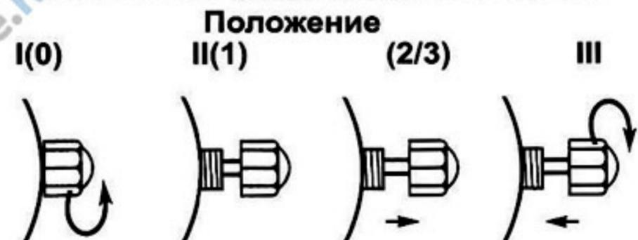
Некоторые часы, прежде всего, являющиеся водонепроницаемыми, на глубине более 50 м (5 атм.), снабжены навинчивающейся заводной головкой. Это указано на этикетке, находящейся на часах. Прежде чем Вы сможете производить корректировки с помощью головки, она должна быть навинчена.
