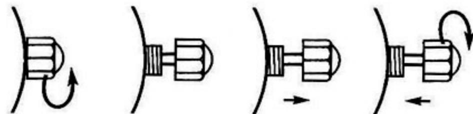
Некоторые часы, в особенности, водонепроницаемые до глубины 50 метров и более, оснащаются завинчивающейся заводной головкой: соответствующая информация приведена на этикетке часов. Перед любыми настройками (даты, времени и т.д.) следует вывинтить заводную головку.
